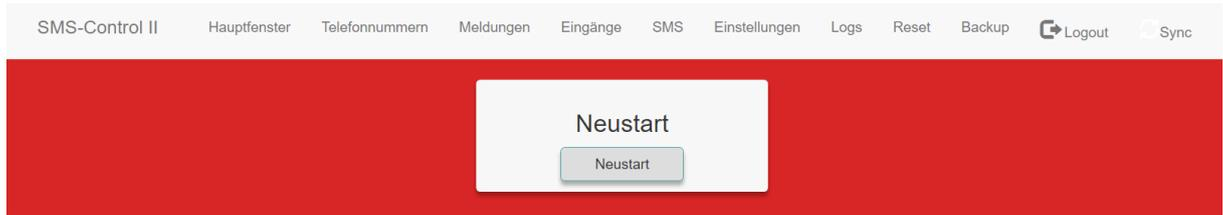
Neustart des SMS-Control-Systems (Achtung, Verzögerung durch Synchronisieren)
