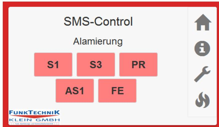
Ist in den Einstellungen die Option Touch-Alarmierung aktiviert können die am Touch-Display sichtbaren Meldungen ausgelöst werden. Wird eine Meldung betätigt muss diese im Pop-up Fenster das sich öffnet bestätigt werden.
